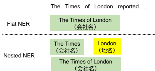
図 2 Flat NER と Nested NER. Flat NER では 1 つの単語は 1 つの固有表現にのみ属するが, Nested NER では複数の固有表現に属する場合がある。
