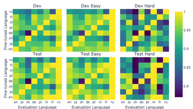
図5 言語モデルの転移性能の評価。y軸に示す各言語でFine-tuning後、x軸方向の言語のテストデータで評価を行う。同一言語で学習と評価を行った場合と比較して、何割程度の評価性能になるか示している。
