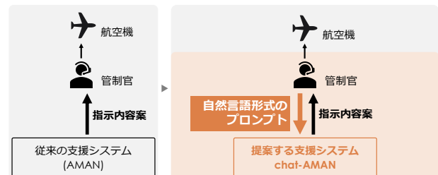
図1 管制の様子の比較：従来の支援システム（左）と提案する chat-AMAN（右）
